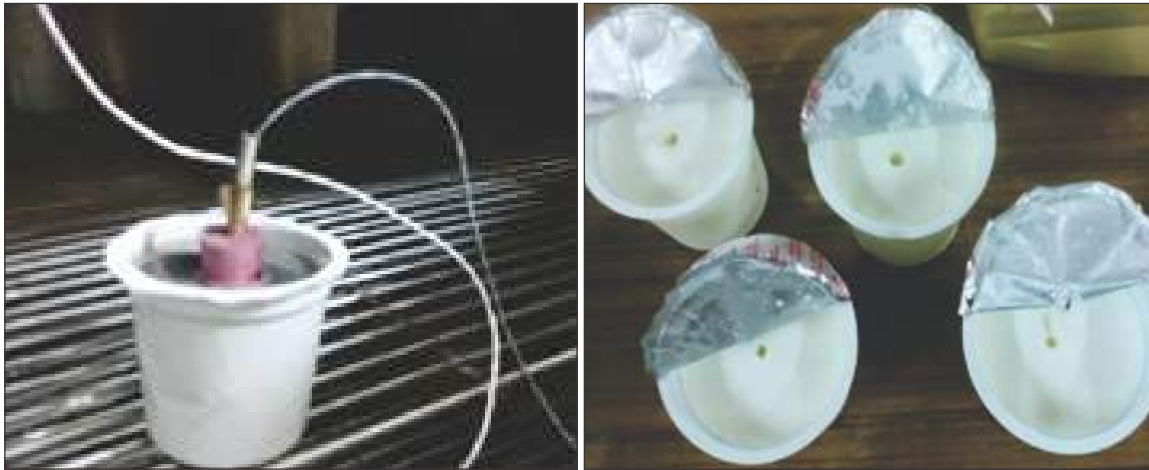
चित्र 2: उत्तम गुणवत्ता के निर्मित दही कप (200 मिली) व सेंसर द्वारा उनका तापक्रम मापन
